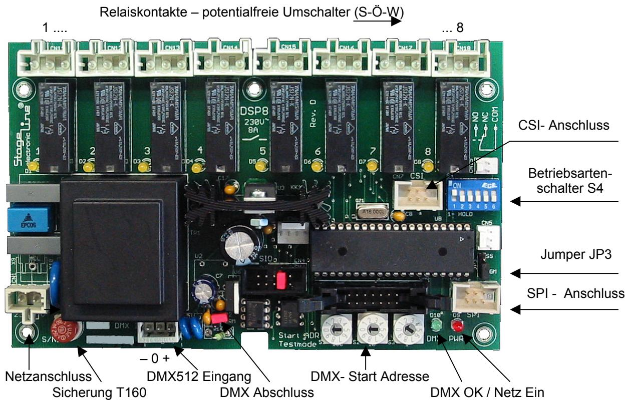
Das DSP8 ist eine DMX512 gesteuerte 8 Kanal Relaisplatine. Jeder der 8 Lastausgänge ist ein potential freier Umschaltkontakt für 230V~/ 8A Dauer- und max. 30A Einschaltstrom.
